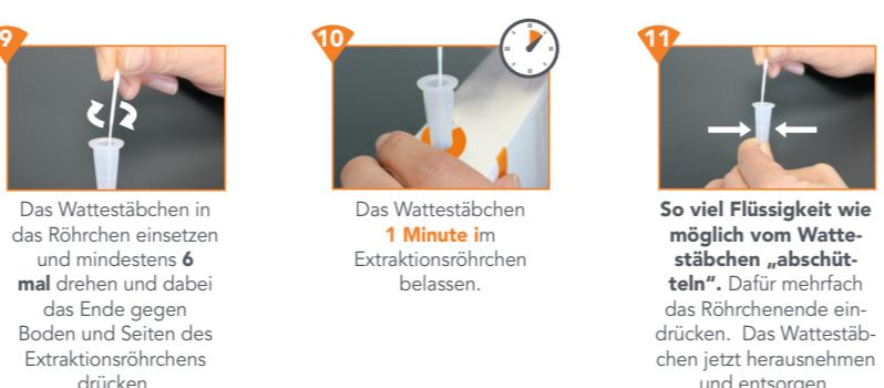
Das Wattestäbchen in das Röhrchen einsetzen und mindestens 6 mal drehen und dabei das Ende gegen Boden und Seiten des Extraktionsröhrchens drücken.
