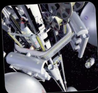
Die heutigen Raumfahrtzentren durch einen Aufzug ins Weltall zu ersetzen, ist der Traum vieler Spezialisten. Um das zu realisieren, benötigt man extrem reißfeste und leichte Materialien, mit denen die Herstellung eines langen Kabels als Verbindung zwischen Raumstation und Erde möglich sein kann. 36.000 km über unseren Köpfen würde dann die Raumstation schweben. Nur Kohlenstoff-Nanoröhrchen können momentan die Bedingungen erfüllen, um solch ein Kabel herzustellen.
