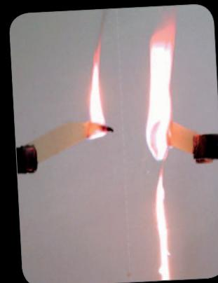
BEISPIEL EINES MIT NANOTEILCHEN GEFÜLLTEN POLYMERS, UM DIE FLAMMFESTIGKEIT ZU VERBESSERN.
