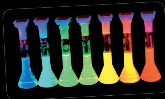
DER DURCHMESSER DER NANOPARTIKEL WIRD VON LINKS NACH RECHTS GRÖßER
